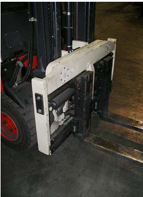
Positionneur TDL 5 T avec fourches FEM permet de changer d'accessoire très rapidement sans aucune difficulté : la polyvalence parfaite.
