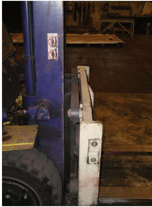
Positionneur TDL Peseur intégré modèle 5 T. L'intégration permet de garder une excellente capacité résiduelle
