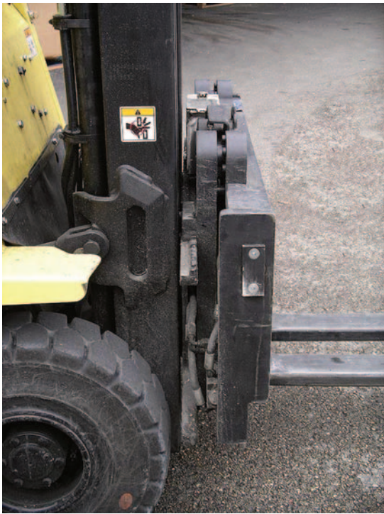
Positionneur TDL Peseur rapporté 2,5 T avec fourches pin-type intégrées faible déport pour cet accessoire combiné
