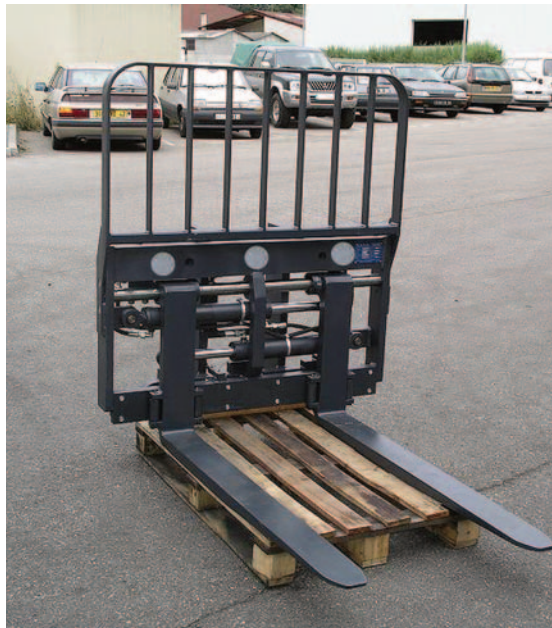
Positionneur TDL Peseur avec dossieret protège charge. La visibilité reste excellente.
