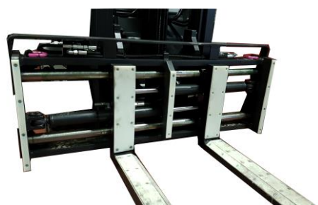
Revêtement sur fourches complètes et face d'appui accessoire (PA6)
