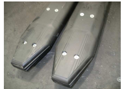
Détail des revêtements anti abrasion sur fourches
