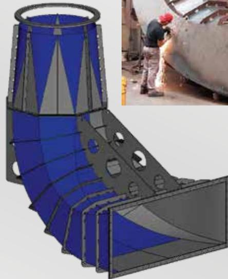
/ Ensemble chaudronné S355 - Barrage hydroélectrique
