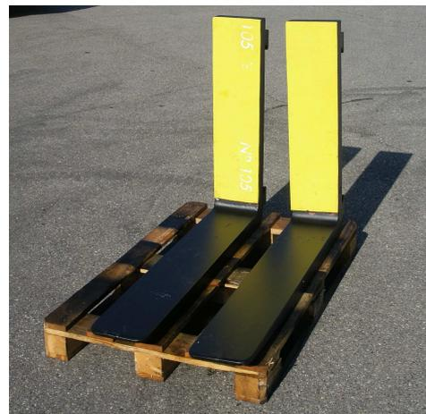
PU-Beschichtung bzw. aufvulkanisiertes Gummi
