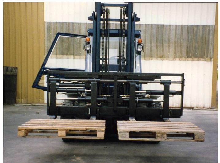
**integrierter Dreifach-Seitenschieber mit Zinkenverstellung**
