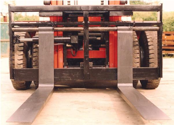
**integrierter Seitenschieber PIN-TYPE**
