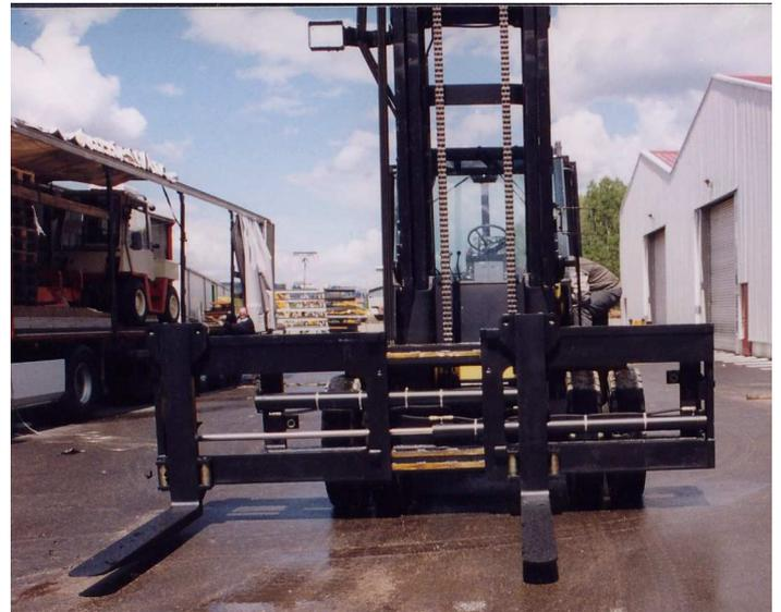
**Seitenschieber/Zinkenversteller mit verstellbarer Rahmenbreite**
