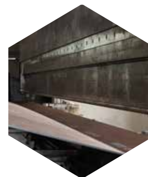
3 presses plieuses de 320 à 1250 T plient avec précision des tôles jusqu'à 9 ml
