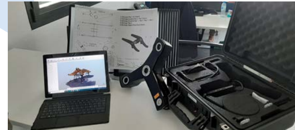
Bras FARO intégré, scanner et palpeur 3D CREAFORM pour une prise de côtes de grande précision
