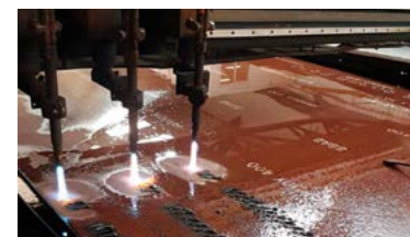
1 table 8000x3000 mm 4 têtes possibilité d'extension jusqu'à 8 chalumeaux
