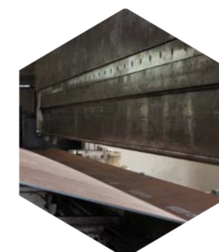
4 presses plieuses de 320 à 1600 T pour des tôles jusqu'à 9 ml
