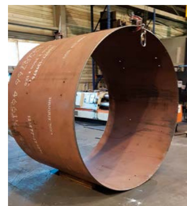
1 rouleuse Ø350 mm / 3 ml - Capacité ép. 20 mm
