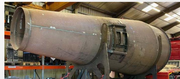
/ Cyclone Hardox® 450 ép. 8 mm Ø 2970 Hauteur 7890 mm
