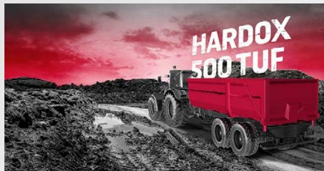
/ Remorque agricole Hardox® 500 Tuf ép. 7 mm
