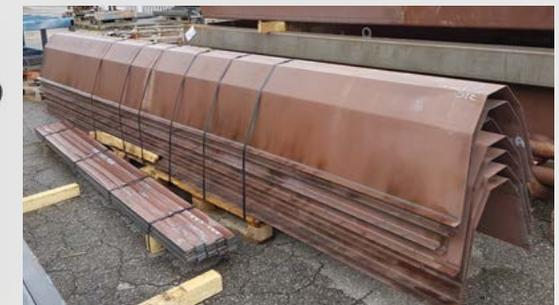
/ Auges de vis sans fin Hardox® ép. 6 mm
