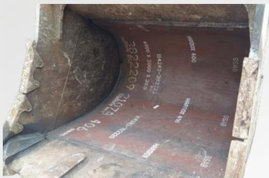
/ Réparation d'un fond de godet ép. 30 mm soudé par notre client
