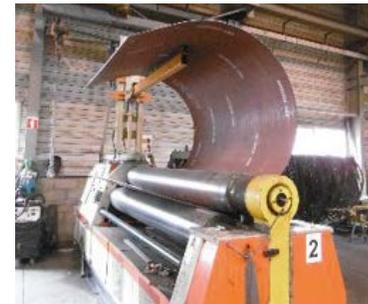
1 rouleuse Ø450 mm / 3 ml - Capacité ép. 35 mm
