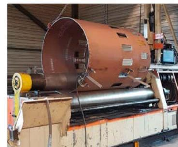
1 rouleuse Ø250 mm / 2,5 ml - Capacité ép. 10 mm
