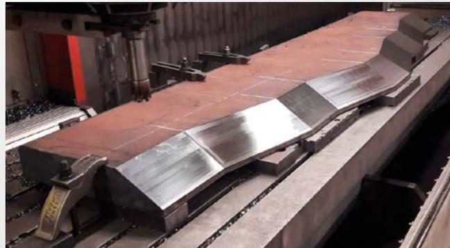
/ *Lame delta mining Hardox® HiTuf ép. 100 mm*
