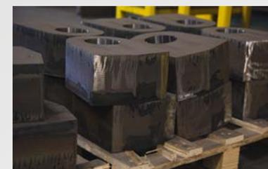
/ Marteaux de broyeur Hardox® HiTuf ép. 130 mm
