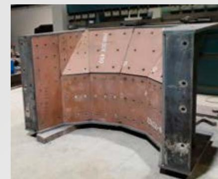
/ Blindages broyeur Hardox® 450 ép. 12 mm
