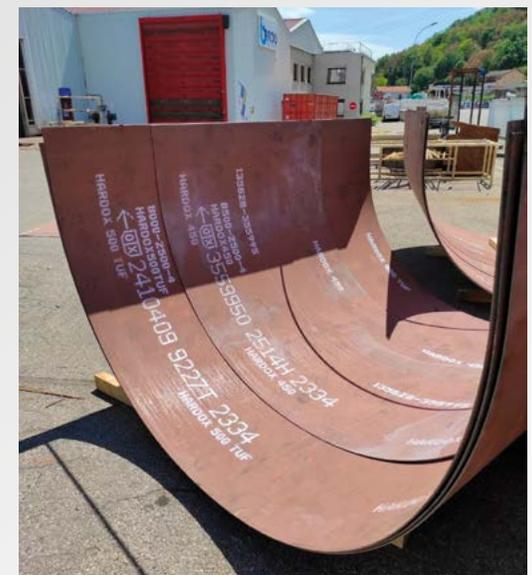
/ Fond de benne Hardox® 500 Tuf ép. 4 mm
