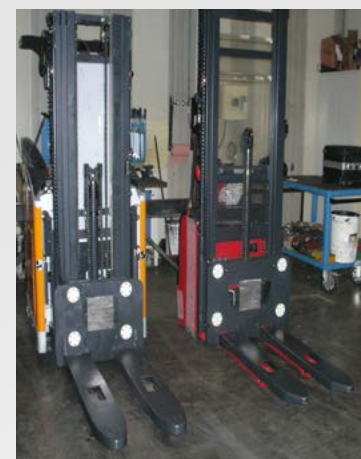
/ Gerbeurs avec pesage intégré
