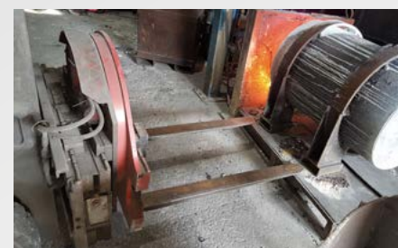
/ Têtes rotatives fonderie avec système de pesage
