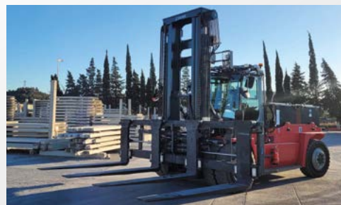
/ Positionneur 4 fourches pour prédalles béton
