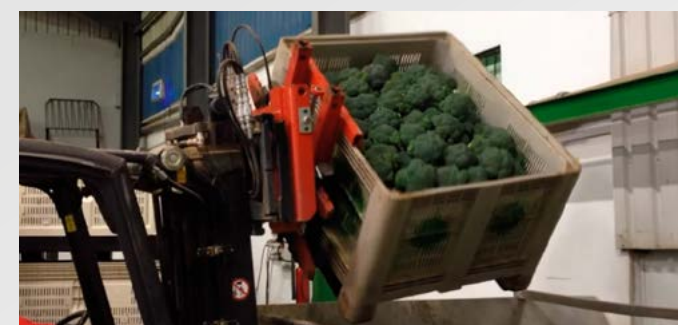
/ Tête rotative renverseur de palox et caisses
