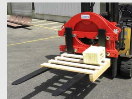
/ Tête rotative avec pesage intégré
