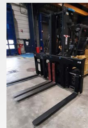
/ Élargisseur sur tablier à dépose rapide
