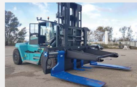
/ Élargisseur stabilisateur pour prise de charges de grandes dimensions
