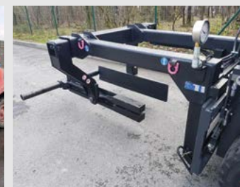
/ Pince pour blocs de béton
