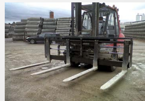
/ Manutention de 1 à 4 buses béton
