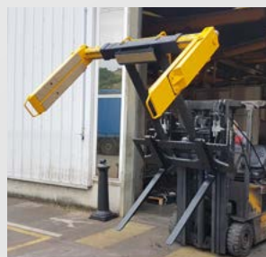
/ Pince pour blocs de polystyrène
