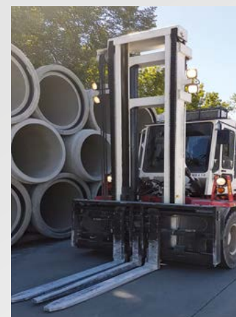
/ Positionneur 3 fourches buses béton
