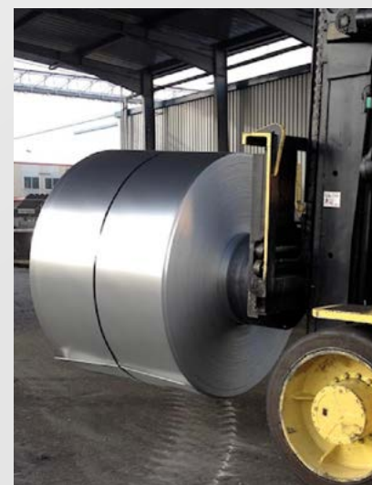
/ Éperon pour manutention de bobines chaudes d'aluminium
