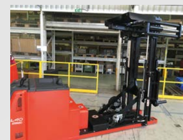
/ Mât porte-bobines avec presseur de maintien
