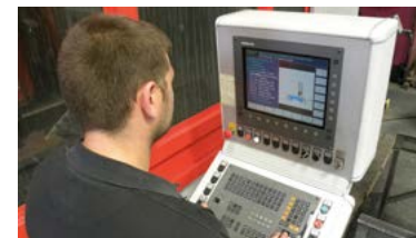
Centre d'usinage CN MATEC 6000x1000 mm 36 outils
