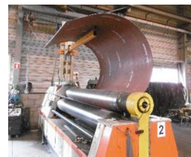
1 rouleuse Ø450 mm / 3 ml - Capacité ép. 35 mm
