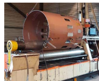
1 rouleuse Ø250 mm / 2,5 ml - Capacité ép. 10 mm
