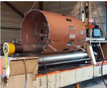
1 rouleuse Ø250 mm / 2,5 ml - Capacité ép. 10 mm
