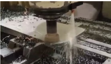
Centre d'usinage CN 4000x1000 mm 24 outils
