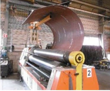
1 rouleuse Ø450 mm / 3 ml - Capacité ép. 35 mm
