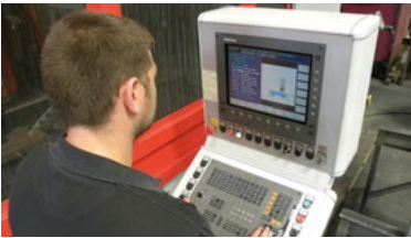
Centre d'usinage CN MATEC 6000x1000 mm 36 outils
