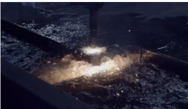
1 table d'oxycoupage 8000x3000 mm découpe immergée jusqu'à 200 mm
