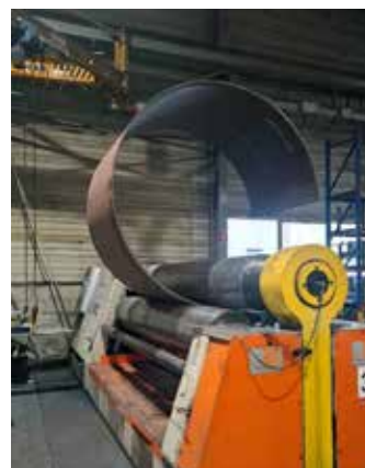
1 rouleuse Ø450 mm 3 ml Capacité ép. 35 mm
