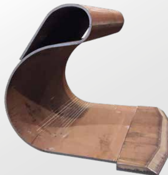
/ Fond Hardox® 450 ép. 25 mm, lame HiTuf ép. 70 mm
