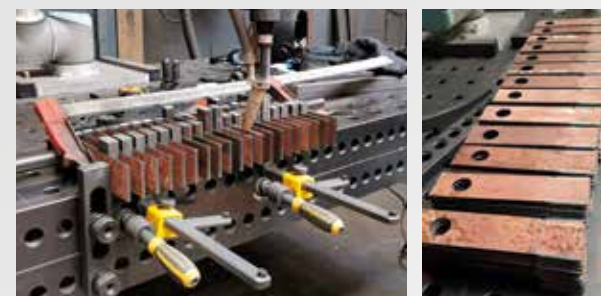
/ Marteaux de broyeurs Hardox® 450 Rechargement carbure de tungstène sur arêtes
